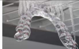
Abb. 6: Gedruckte Schiene mit Supports
